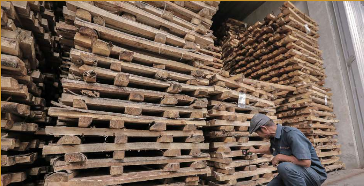
moisture content checking
